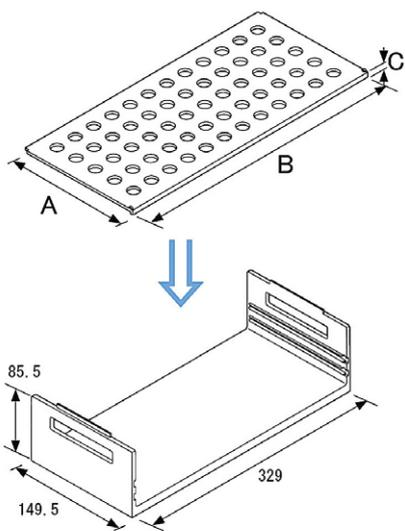
※一段目プレート装着時、底からプレート上部まで18.2mm
